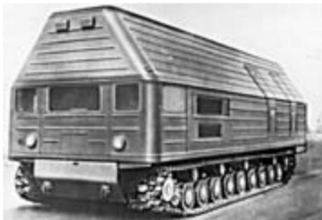
В 1957 году эскизный проект передвижной станции был готов. На реакторе Первой в мире АЭС на петле высокого давления проводились испытания топливных композиций и конструкций твэлов водо-водяного реактора (ВВЭР) установки. Через четыре года на территории ФЭИ была пущена транспортная атомная электростанция ТЭС-3 на гусеничных платформах мощностью 1500 кВт.
