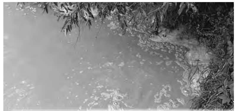
Серовато-белесый цвет воды характерен при сливе промраствора с бетономитом
