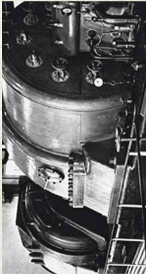
Турбина Первой АЭС — знаменитая Маня, сделанная еще в начале XX века германской фирмой MAN.
